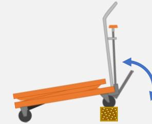
操作側を50mm程度持上げてペダルを漕ぐ(空漕ぎでも普通に漕いでも良い)。ペダルは最後までしっかり押すこと。(プランジヤー内のエアがプランジヤーから抜ける)
