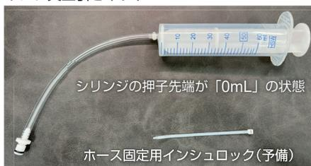
② シリンジの押し先端が「0mL」の状態であることを確認し、本機の OUT 側にポンプ真空引きキットを接続してください。製品へ差し込んだ時に「カチッ」という音が鳴れば、接続できています。
