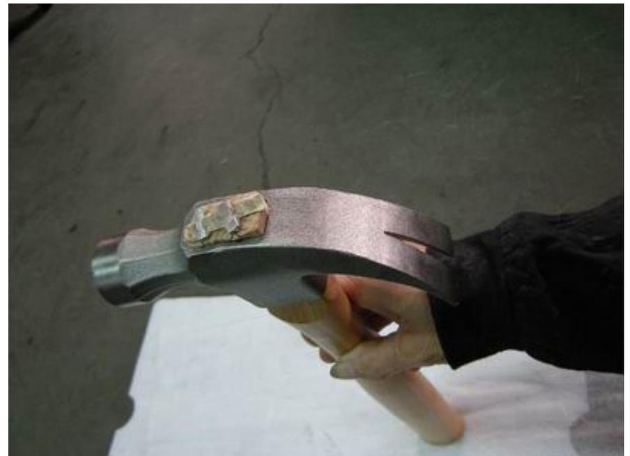
⑥ 研磨機で突き出した部分を研磨します。
