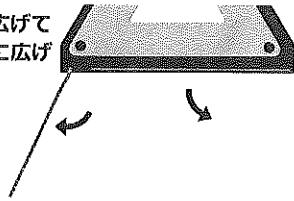
5 三角停止板は、反射板を後方に向けて、後続車に見やすいように設置してください。
