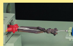
絶縁被膜接着テスト
