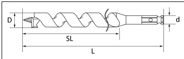
サイズ:D 全長:L ネジ丈:SL 軸径:d
