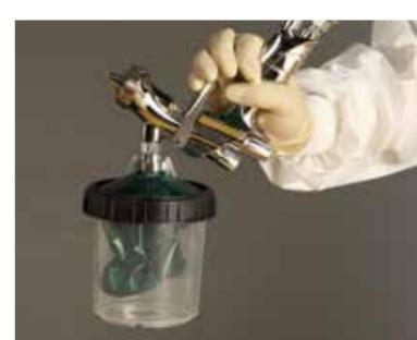
1. エアホースを差し込み、スプレーガンを逆さにしトリガーを引き、ライナー内の空気を抜きます。
