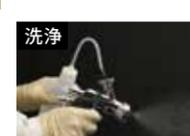
洗浄 スプレーガンのみを洗浄液で洗浄します。水性塗料をご使用の場合、洗浄にポンプアップスプレーを使用すると便利です。
