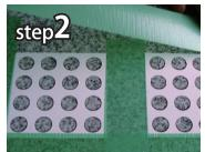
お好みのパターンになるようにマ スキングします。このとき専用の パターンシートを使うと手軽に 模様が作れます。塗料が付くと困る 場所にはマスキングテープなどで 養牛しておきます。
