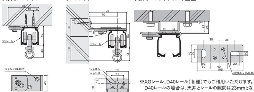
※XGレール、D40レール(各種)でもご利用いただけます。D40レールの場合は、天井とレールの隙間は23mmとなります。
