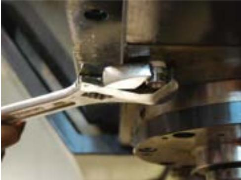
③次に接続するジョイントホースをコネクタのR部分に押し当てた後、ナットを仮締めして下さい。
