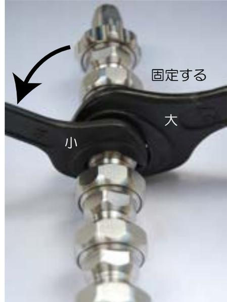
④レンチでゆるめたナットがはずれた状態。
