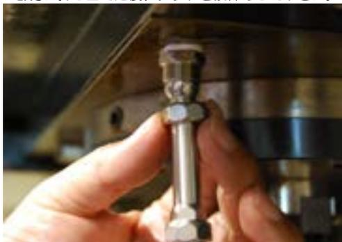
④付属のレンチでナットをしっかりと締め付けて下さい。
