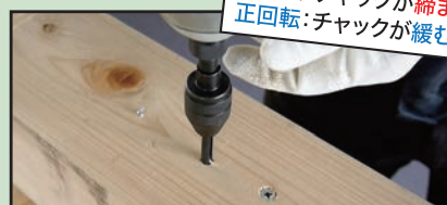
③インパクトドライバに逆回転チャックを装着しチャックに専用ピンをくわえさせる。
