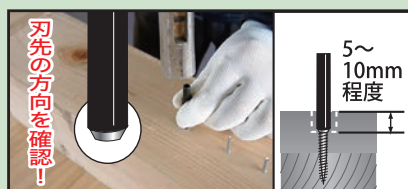
②専用ピンを折れたビスにハンマーで5mm～10mm程度、打ち込む。
