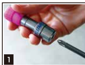
1 段付ビットに本体をセットする
