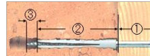
重要：施工時に 1xネジ径 以上をプラグ貫通して下さい。
