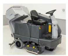
バッテリータンクへのアクセスが容易な 開閉式回収タンク
