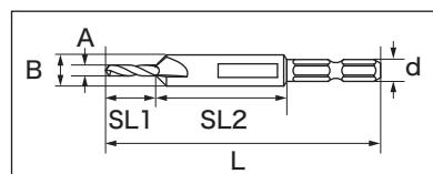
サイズ(mm)：下穴(A)x皿取(B) 寸法(mm)：全長Lxネジ丈SL1xSL2x軸径d
