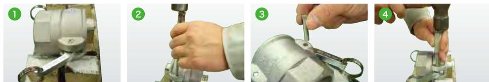
1 ローレット加工部を下にして台にセットします。
