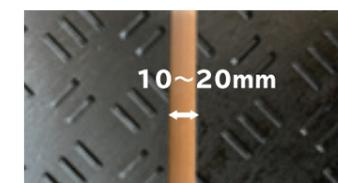
プラスチック素材のため温度変化により伸縮します。複数枚敷き並べる場合は、敷板同士に隙間を10~20mmあけてください。
