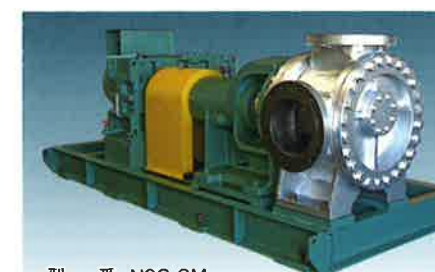
型番 N9G-CM 液名 ポリマーソリューション 粘度 30000mPa.s 温度 100℃ 吐出量 60m 3 /h 圧力 1.2MPa 回転数 51min -1 電動機 75kW
