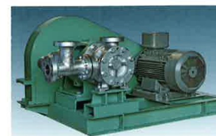
型番 N4G-MF 液名 グリース 粘度 15000~70000mPa.s 温度 100℃ 吐出量 6.6m 3 /h 圧力 2.0MPa 回転数 190min -1 電動機 15kW
