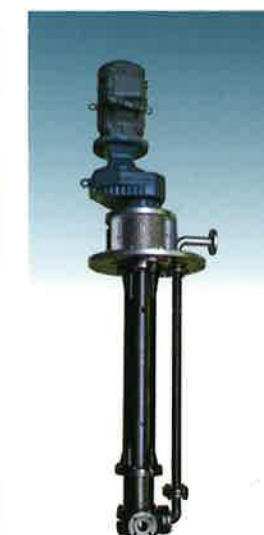
型番 N3G-MV 液名 タールピッチ 粘度 20mPa.s 温度 200~230℃ 吐出量 1.8m 3 /h 圧力 2.3MPa 回転数 463min -1 電動機 7.5kW
