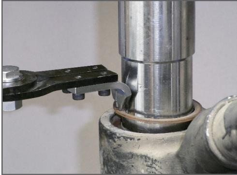
●ラチェット機構付きなので、スムーズにスナップリングが収縮でき、安全簡単に脱着作業ができます！！
