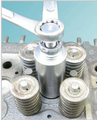
巻き上げナットでノズルチューブを抜き取ります。
