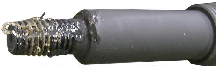
※アタッチメント先端に少量のグリスを塗布しておくとして作業時に出る切粉を燃焼室への落下防止になります。
