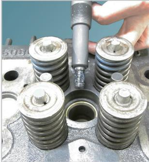
お手持ちのラチェットハンドルとソケット (22mm) でアタッチメントを上から押さえつけながら締め込み、アタッチメントをノズルチューブにしっかりと喰い付けさせます。
