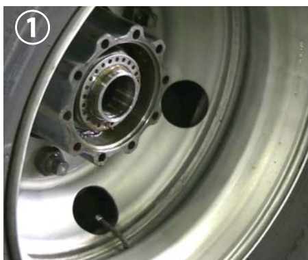
① 車両側のリアシャフト等を 取りはずします。
