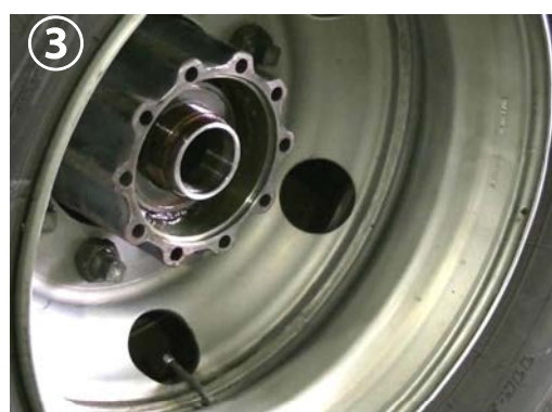
③ ハウジングナットを取り外した状態 ※締め付け時は必ず整備要領書に従って 作業を行ってください。 インパクトレンチなどは使用しないで ください。
