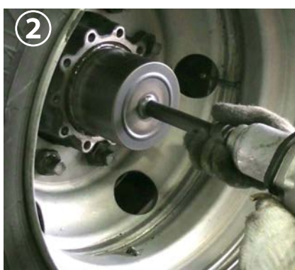
② 車両のハウジングナットに合う サイズを選び必ず低圧のインパクト レンチにて緩めます。
