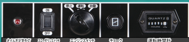
オイル不足警告灯 スローダウンスイッチ エンジンスイッチ チョーク 運転時間計
