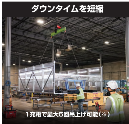
※M18 12.0Ahバッテリー装着時に、1トンの荷重を18.3メートル上昇・下降した場合
