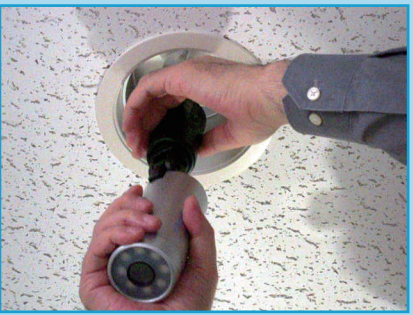
プラグインカムをソケットに差し込みます
