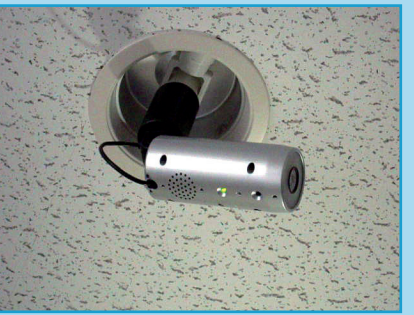
プラグインカムをソケットに差し込みます
