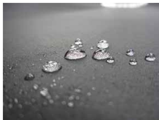
TX加工を施した製品表面の撥水効果
