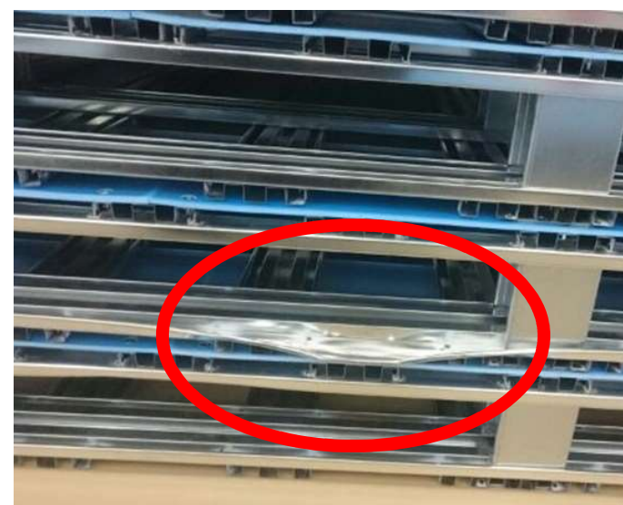
ライトパレットは変形するが 破片は出ない
