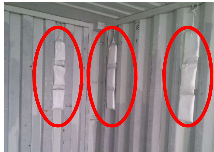
※結露対策の為に乾燥剤を使用したイメージ図
