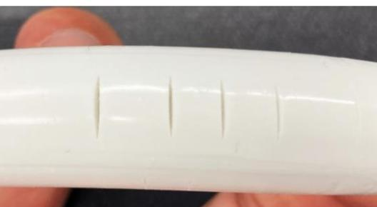
写真のような裂け目や傷の有無で裂傷になりえる危険性があるか評価、確認ができます。
