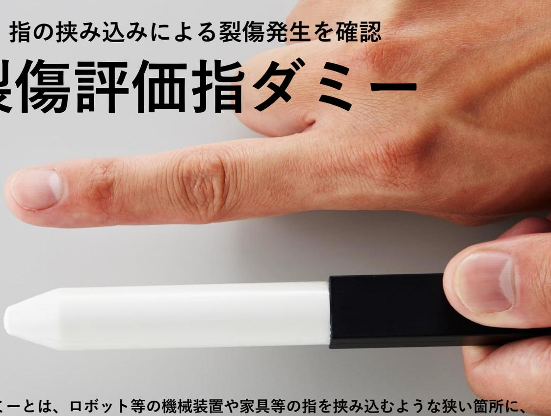
裂傷評価用指ダミーとは、ロボット等の機械装置や家具等の指を挟み込むような狭い箇所に、人体に代わって挟み込み、裂傷が発生しないかどうかを確認するためのダミーです。
