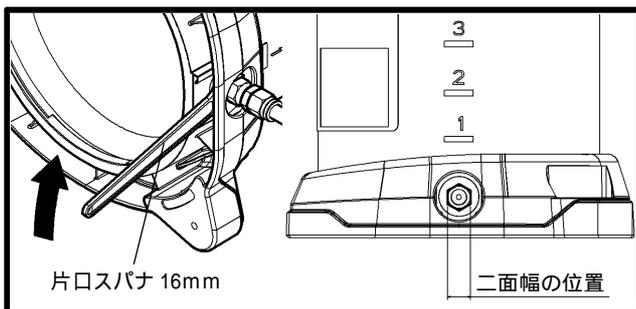
継手ゆるみ止めプレートの向きに注意して、溝にしっかりとめ込んでください。
