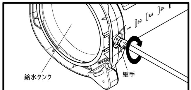
片口スパナ 16mmで締め込んでください。その際に、二面幅の向きを図の位置に調整してください。
