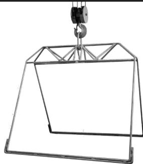
① 吊り金具の型式を確認した後楕円リンクにクレーンフックを掛けます。
