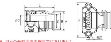
HYBRID 衛生構造 + 漏れ抜け防止構造 + 簡単挿入構造の複合 注意 日々の分解洗浄用継手ではありません。
