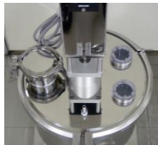
蓋への覗き窓追加加工
