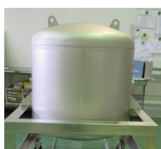
バフファ加圧タンク
