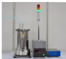
ロードセル式残量測定
