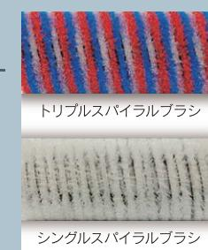
トリプルスパイラルブラシはシングルに比べ傾斜角度が大きくなることで、板に対する接触面積が大きくなり洗浄力が向上されます。
