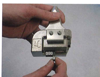
②使用する刻印を手打ちホルダーへ差込みます。
