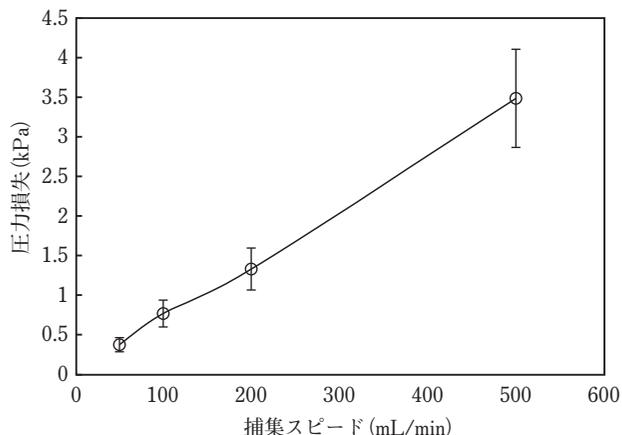
自動ガス採取装置の設定捕集スピードに対する圧力損失が定流量使用範囲を超えた場合、設定流量で吸引できなくなります。
