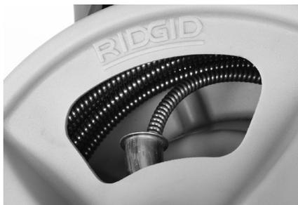
図 18 - ケーブルを図のようにドラムに巻き入れます
