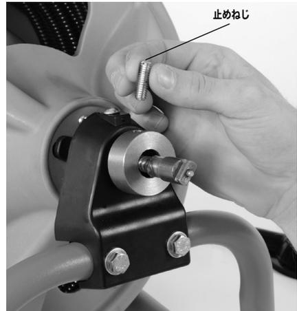
図 3 - ケーブル固定用の止めねじを取り外す
