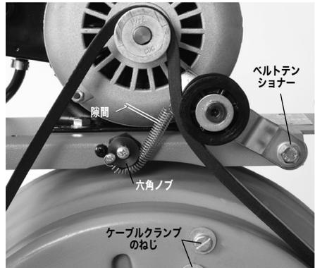
図 17—トルクリミッターを調整する。（ベルトガードを取り外した状態）
