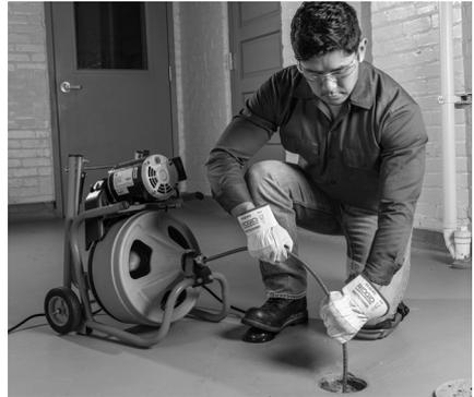
図 13 - 操作位置、手動でのケーブルの送り込み
