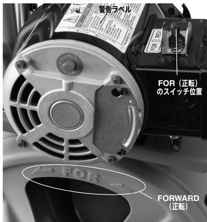
図8-ドラムの正しい回転方向
