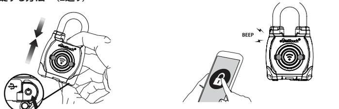
(i) シャックルを図のようにロック本体に格納してから下部の電源ボタンを押します。ビープ音がなったら完全施錠されたサインです。
