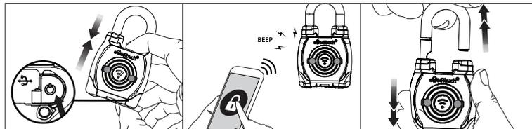
ロック本体の下部にある電源ボタンを押し、ONにします。本体中央のLEDランプが青く点滅します。
