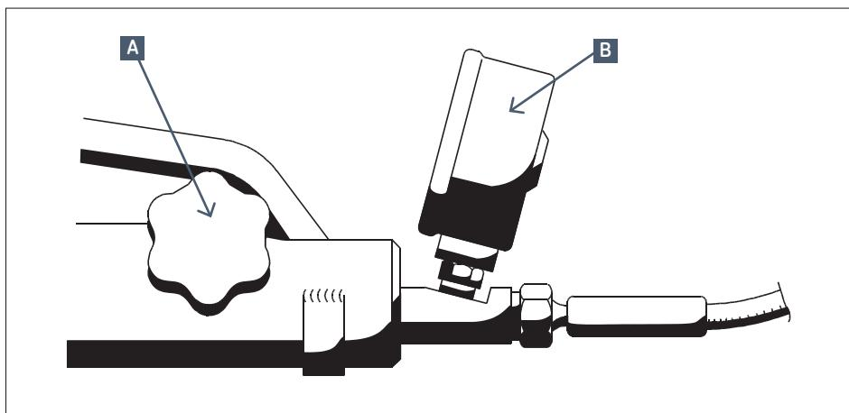
A. Ventil pro vypuštění oleje
