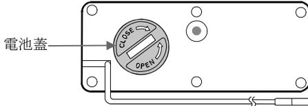
1. 温度計を裏返して、コインを使って電池蓋を反時計の方向（左回り）に回してはずします。
