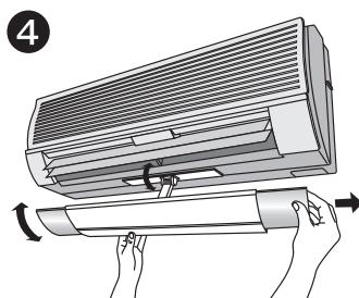
エアコンの風向きに合わせて本体角度と伸縮カバーの長さを調節します。
