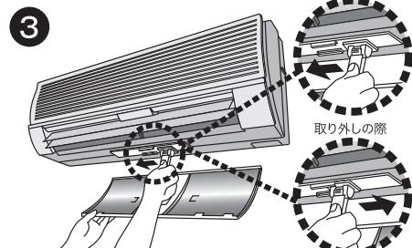
本体カバーに取り付けた角度調節アームをエアコンに貼った固定板の溝に合わせ、矢印の方向へ「カチッ」と音がするまで差し込んでください。
