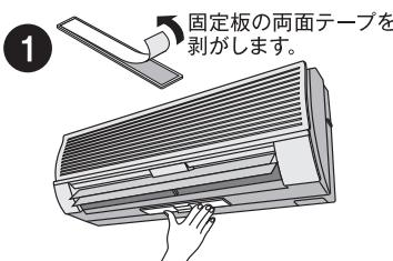
固定板をエアコンに取り付けるときは、親指などで指圧をかけて固定板表面全体を押してしっかりと固定してください。
