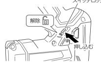
スイッチロックを「解除」側にした状態で、 スイッチを引くとモーターが起動し、はな すと停止します。
