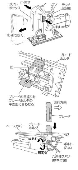
「タストボックスをベースのレール部に沿ってスライドさせ、ラッチが「カチッ」と音がするまでしっかりと押し込み、ダストボックスを機体に取付けます。
