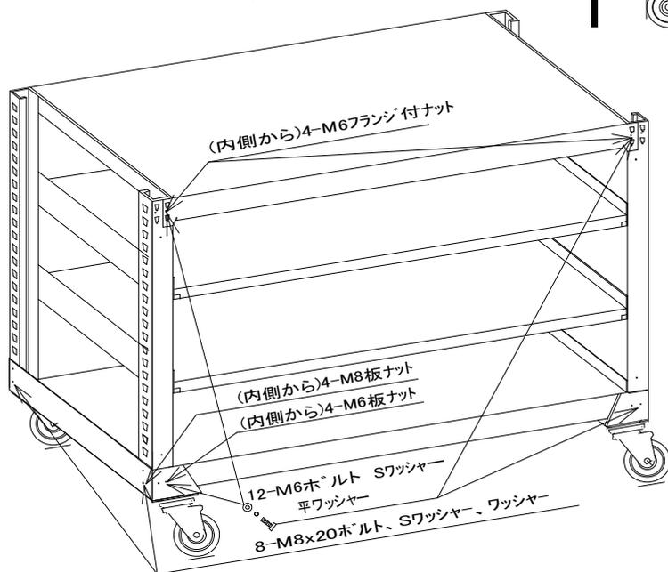
※下部ビーム用穴はM6板ナットを支柱中により入れ、ベースユニット外側よりM6ボルトセットを取り付けます。
