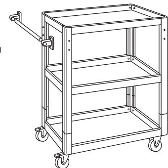
右側のパイプ取り付けブラケットの内側にある突起に、ハンドルパイプの切り込みを合わせて組み立ててください。
