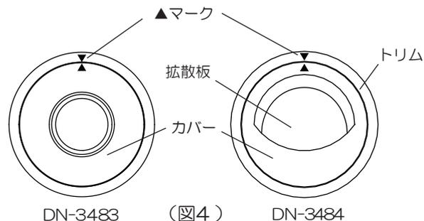
●もしも拡散板が外れてしまったら・・・(DN-3484の場合)
