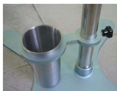
液垂れ受けを液垂れ受け部 に設置した様子
