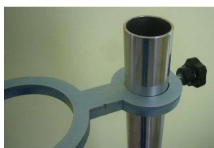
アダプタ下の支柱差込み部 を支柱に差し込んだ様子
