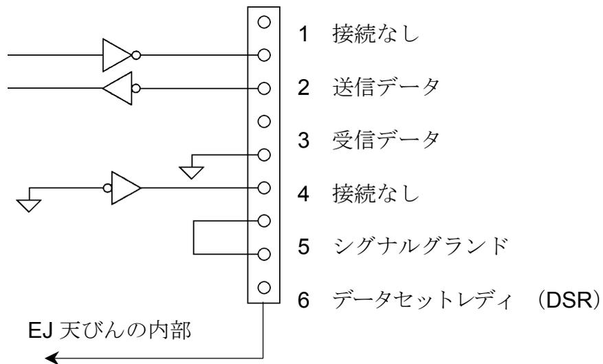
インタフェースは、DCE (Data Communication Equipment) として示されます。
