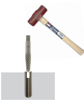
下穴にエキストラクターをハンマー等で軽く打ち込む
