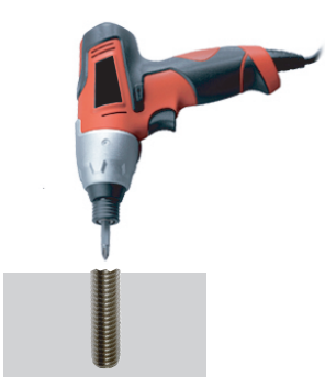
折れ込んでいるボルトに適合するドリルで下穴をあけます。
