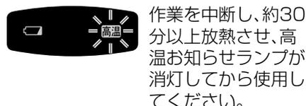
作業を中断し、約30分以上放熱させ、高温お知らせランプが消灯してから使用してください。
