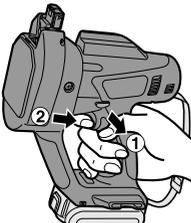
①動作切替スイッチを**切断**位置にし
