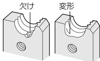
刃部に欠けや変形が生じたら可動刃と固定刃を同時に交換する
