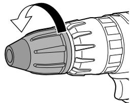
③ キイレスチャック内部の固定ネジ(左ネジ)をマイナスドライバーで正面から見て左方向に強く締め付ける。
