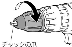
② キイレスチャックを正面から見て左方向に回し、チャックの爪を開く。
