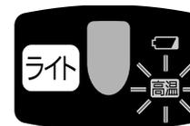
作業を中断し、約30分以上放熱させ、高温お知らせランプが消灯してから使用してください。
