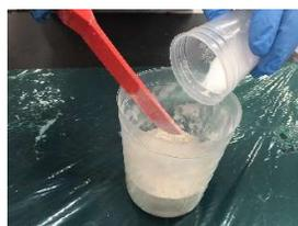
PC 9410 (FGM)の砂礫(されき)にPC 7257Summer(硬化抑制剤)を添加混合後、アクチベーター混合
