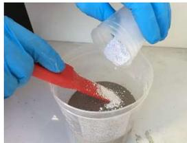
砂礫(されき)とアクチベーター混合後のPC 9410 (FGM)にPC 7257Winter (硬化促進剤)を添加混合
