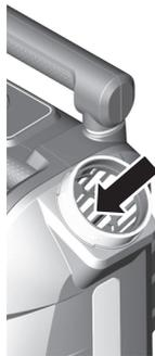
5. タンクキャップ③を取り付け、矢印の方向に回して締めます。タンクキャップ③は確実に締めてください。
