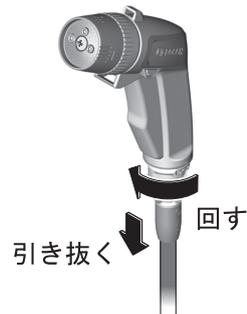
2. 本体の水出し口⑤から“専用ツイストコネクター”を取り外します。
