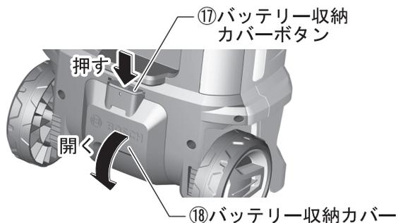
2. 「バッテリー取り外しボタン」を押しながら、バッテリーをコードレス洗淨機本体から引き抜きます。
